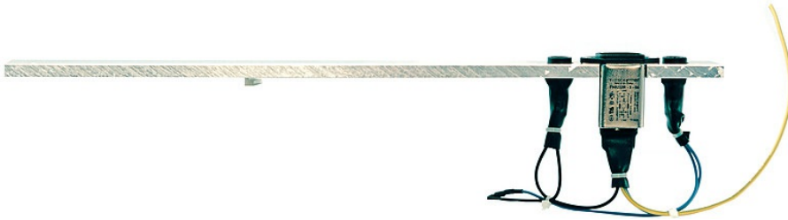
Netzeingangsmodul komplett bestückt, verdrahtet
