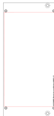
NIM3/12 Bestückungsfläche auf der Frontplatte 183,8 x 100,0 mm
